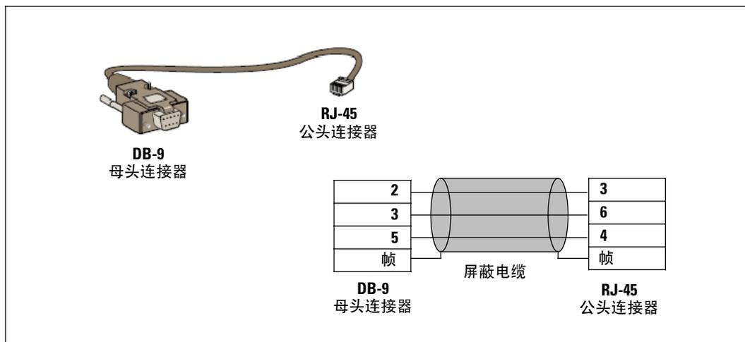
图 37. DB-9/RJ-45 通信电缆和插脚说明
